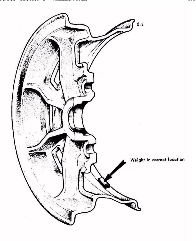
Fig. 1. ALLOY WHEEL SHOWING CORRECT LOCATION OF BALANCE WEIGHTS.
